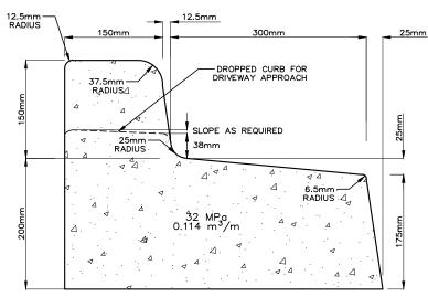
SUPERELEVATED CURB & GUTTER
