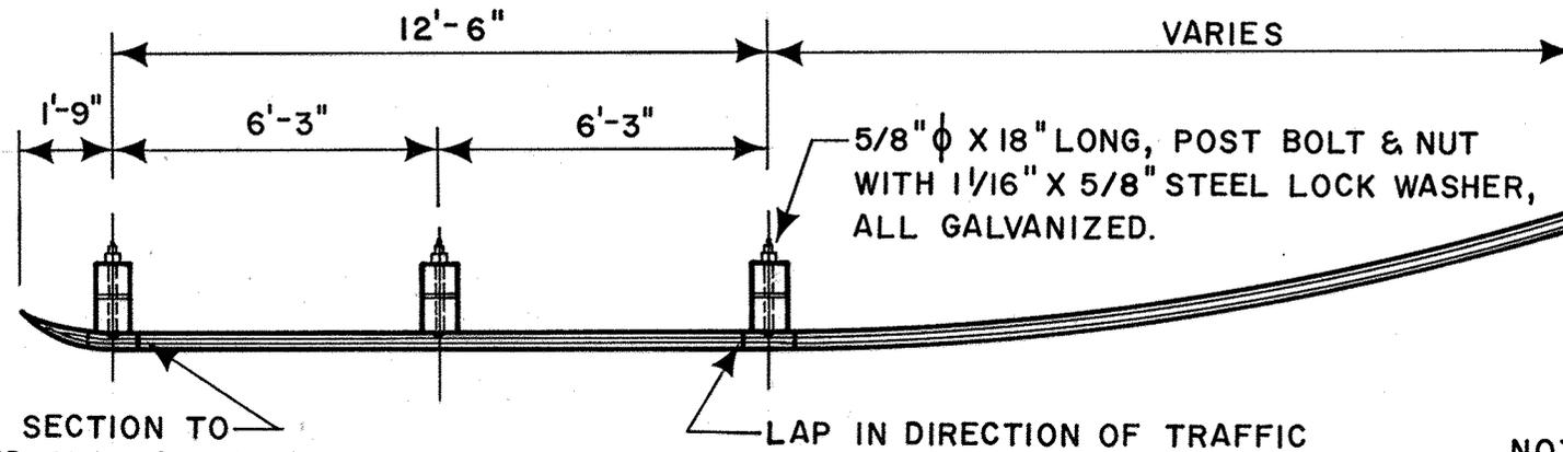
TERMINAL SECTION TO BE LAPPED ON TRAFFIC FACE
